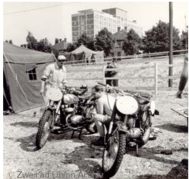
250er mit JLO-Zweizylinder und 175 cm 3 mit Sachs-Motor (v.l.)
